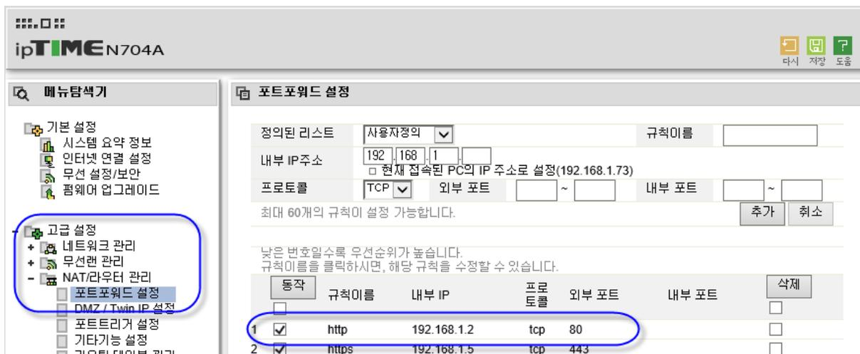
그림 16.74 화면에서는 공용 IP로 80포트를 통해 들어오는 요청을 공유기에 연결된 컴퓨터 중에서 192.168.1.2 내부 IP 주소를 가진 컴퓨터로 전달하도록 설정한 예를 보여준다. 물론 이 설정은 여러분의 상황에 맞게 해야 한다. 여기까지 설정했으면 이제 당당하게 친구에게 IP 주소를 알려주고 여러분이 만든 홈페이지를 자랑해 보자.
