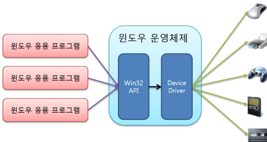
보다시피 윈도우 프로그램은 각종 장치를 직접 제어하지 않는다. 윈도우는 연결될 장치에 대해 그 장치의 사용법을 가장 잘 아는 제조사가 장치 드라이버(Device Driver)를 함께 제공하게 한다. 그리고 API를 통해 장치 드라이버의 기능을 노출한다. 그 덕분에 장치 드라이버가 바뀌었다고 해서 윈도우 응용 프로그램이 바뀌지는 않는다. 이 상황을 "프린터"로 설명해 보자. 프로그램에서는 인쇄를 위해 Win32 API를 사용해 인쇄 작업을 수행할 수 있다. 윈도우는 A 제조사에서 만든 프린터와 장치 드라이버가 있다면 그것을 사용해 인쇄 작업을 연결한다. 또는 B 제조사에서 만든 프린터가 있다면 역시 그 장치 드라이버를 이용해 인쇄 작업을 수행함으로써 윈도우 응용 프로그램과 장치 드라이버 사이의 직접적인 의존성을 제거한다.
